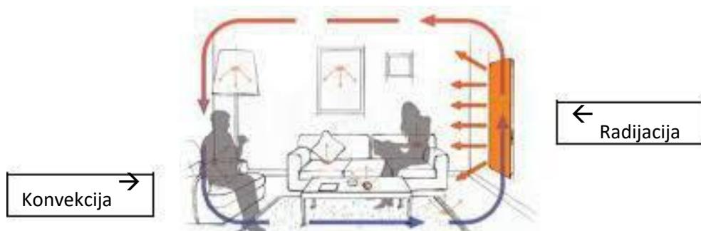
Nakon postizanja tražene temperature u prostoru, potpuno se isključuje potrošnja električne energije, a temperatura u prostoru održava kroz akumuliranu energiju u termo blokovima od specijalne keramike. Zbog njihove sposobnosti da vrlo dugo zadržavaju toplinu, tražena temperatura u prostoru se održava uz povremeno kratkotrajno ponovno uključivanje napajanja, tj. uz minimalnu potrošnju električne energije:
