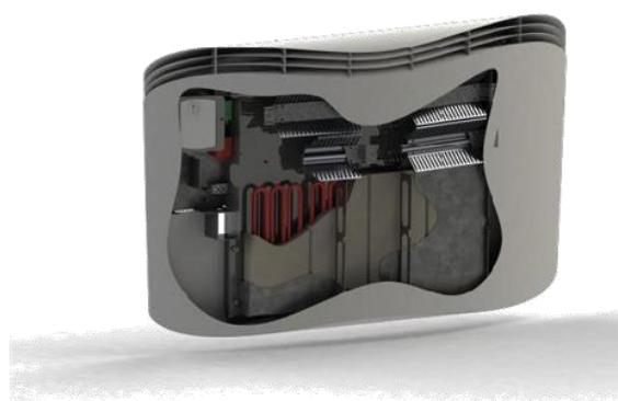
Brzi početni prijenos topline u grijani prostor postiže se usmjerenim strujanjem (konvekcijom) zraka korištenjem niskotemperaturenih grijaća s aluminijskim difuzorima velike površine. Ovo omogućuje brže zagrijavanje zraka na nižim radnim temperaturama.
